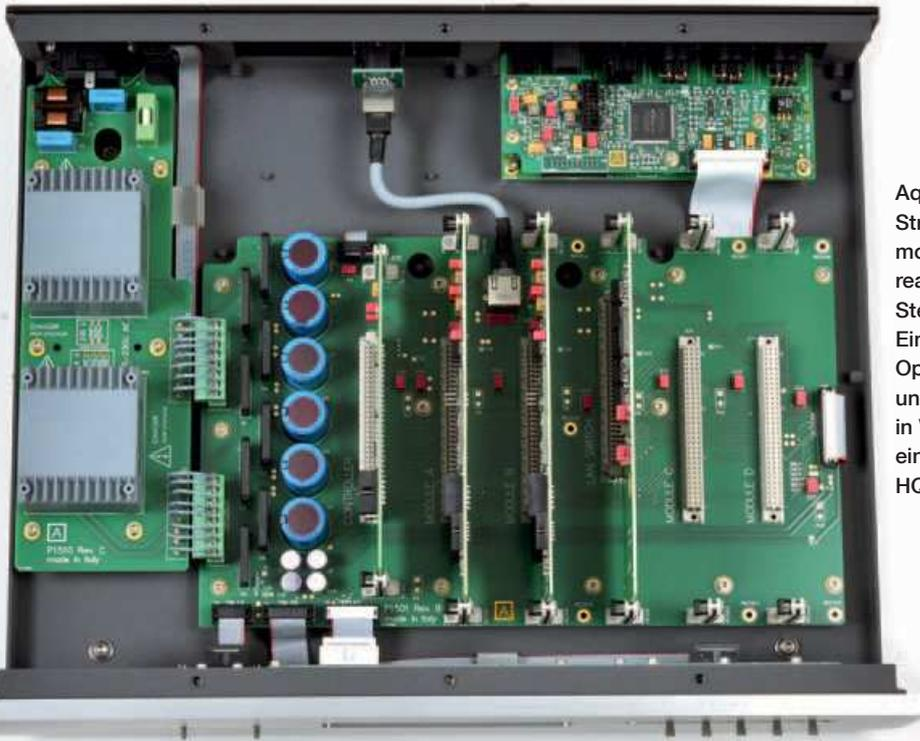
Aqua hat den Streamer LinQ modular aufgebaut, realisiert durch Steckplatten. Zwei Eingänge sind für OpenHome/UPnP und Roon belegt, in Vorbereitung ist ein Modul für den HQPlayer/NAA.
