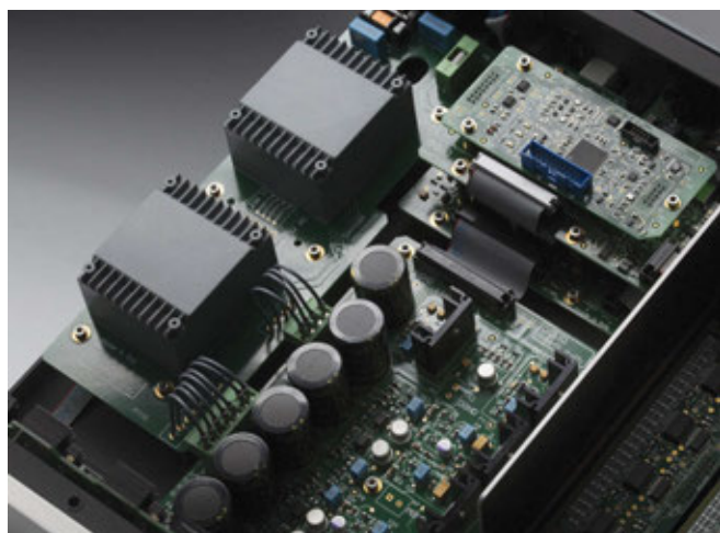
La parte di sinistra della macchina contiene l’alimentazione: si notino i due trasformatori separati per la sezione digitale e per quella analogica.
