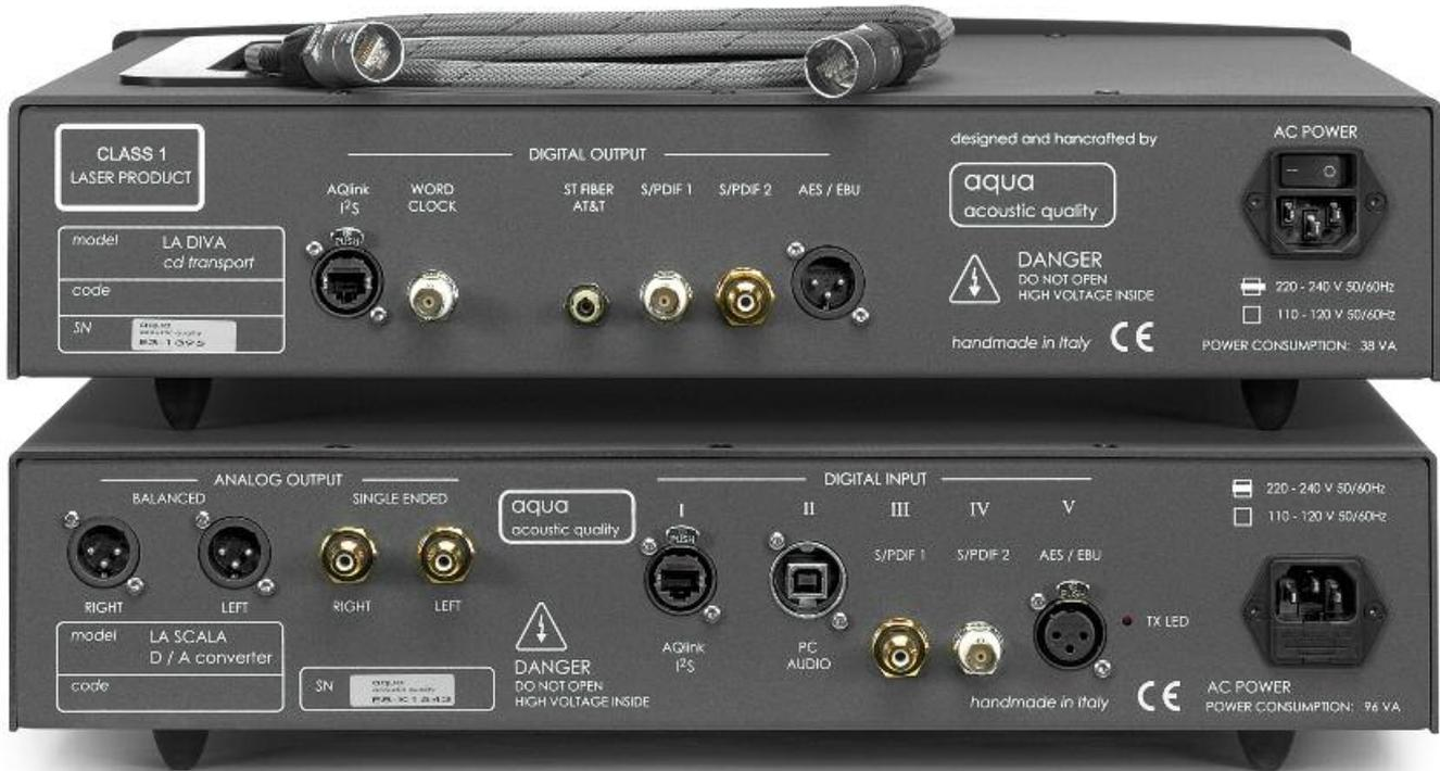
Laufwerk und Wandler sind reichlich mit Anschlüssen versehen. An der Rückseite des La Diva (oben) sitzen von links nach rechts die Buchsen für AQlink (I<sup>2</sup>S-Protokoll), Word Clock, ST FIBER AT&T, S/PDIF BNC, S/PDIF Cinch, AES/EBU.
