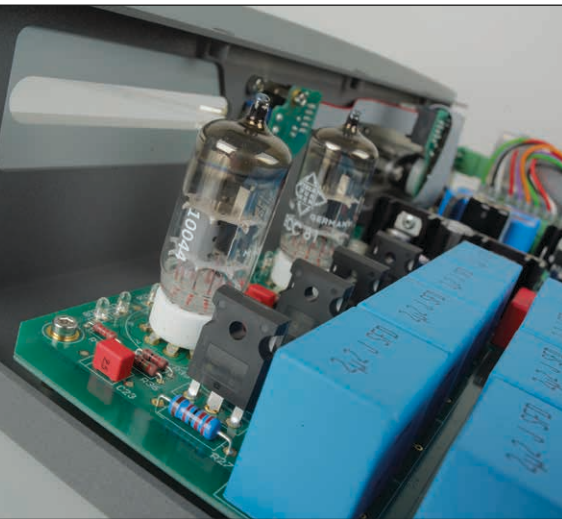
Die hybride Ausgangsstufe mit den beiden ECC-81-Röhren harmoniert gut mit dem Klang des Ladder-DACs
