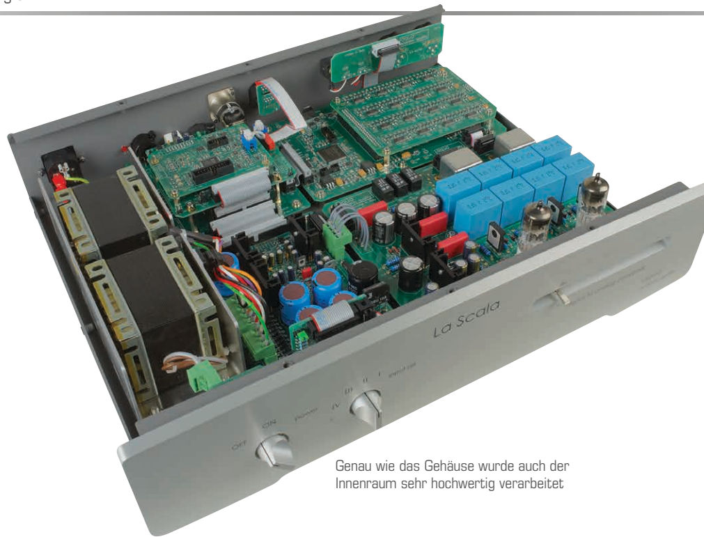
Die hybride Ausgangsstufe mit den beiden ECC-81-Röhren harmoniert gut mit dem Klang des Ladder-DACs
