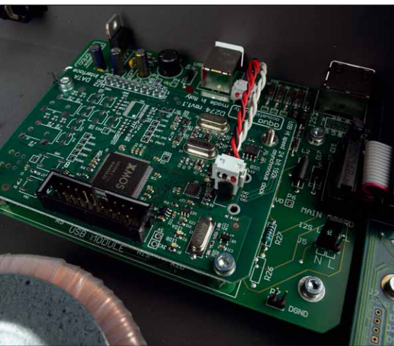
Die asynchrone USB-Schnittstelle wird von einem XMOS-Receiver gesteuert
